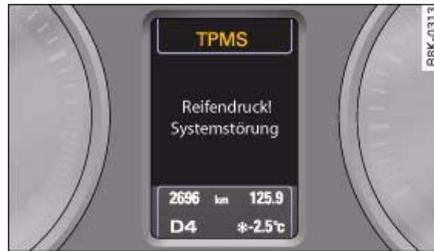
Fig. 28 Display: System fault ("Systemstörung")
